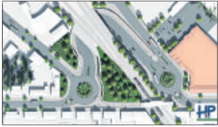
Die Tunnelösung mit der Schleife und den beiden Kreisverkehren aus der Vogelperspektive. Fotos: H&P Ingenieure GmbH
