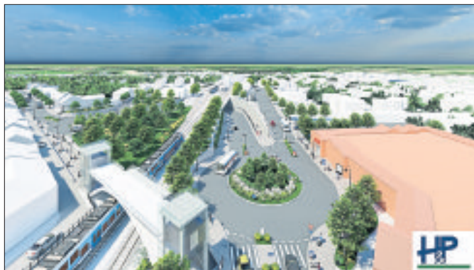
Eine Visualisierung des Ingenieurbüros „H&P Ingenieure“: Die Planung sieht einen Tunnel abseits der Walsroder Straße vor, der über zwei Kreisverkehre und eine Schleife durchfahren werden kann.
