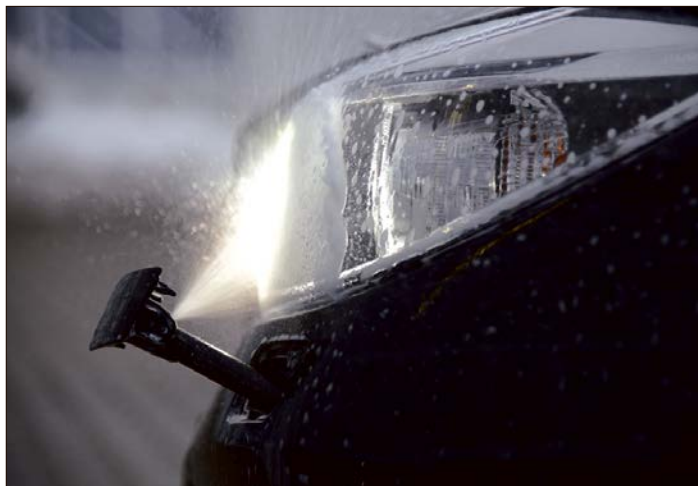
Gut geduscht: Eine Scheinwerfer-Reinigungsanlage verhindert Blendung und schafft optimale Sicht. Werkfoto: TÜV Süd
