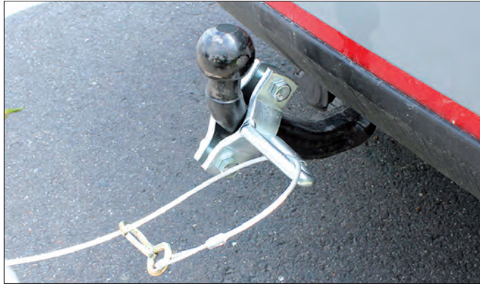
Autofahrer, die einen Pkw mit gebremstem Anhänger nutzen, sollten auf ein Abreißseil nicht verzichten. Werkfoto: Rameder
