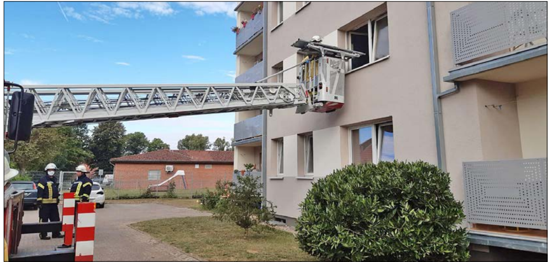
Die Drehleiter mit Krankentragehalterung ermöglicht einen schonenden Patiententransport aus der Wohnung eines Mehrfamilienhauses ins Freie zum Krankenwagen.
