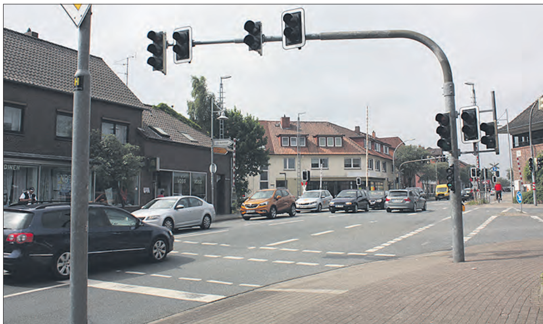
Die Ampelanlage in der Walsroder Straße im „Überblick“: Sowohl über beiden Fahrspuren als auch am Mast neben der rechten Spur hängt eine Bahnampel.
