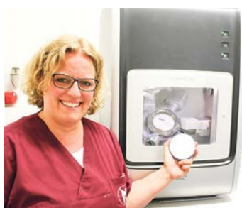
In kürzester Zeit fertigt die neue 5-Achs-Fräsmaschine aus einem Rohling den Zahnersatz
