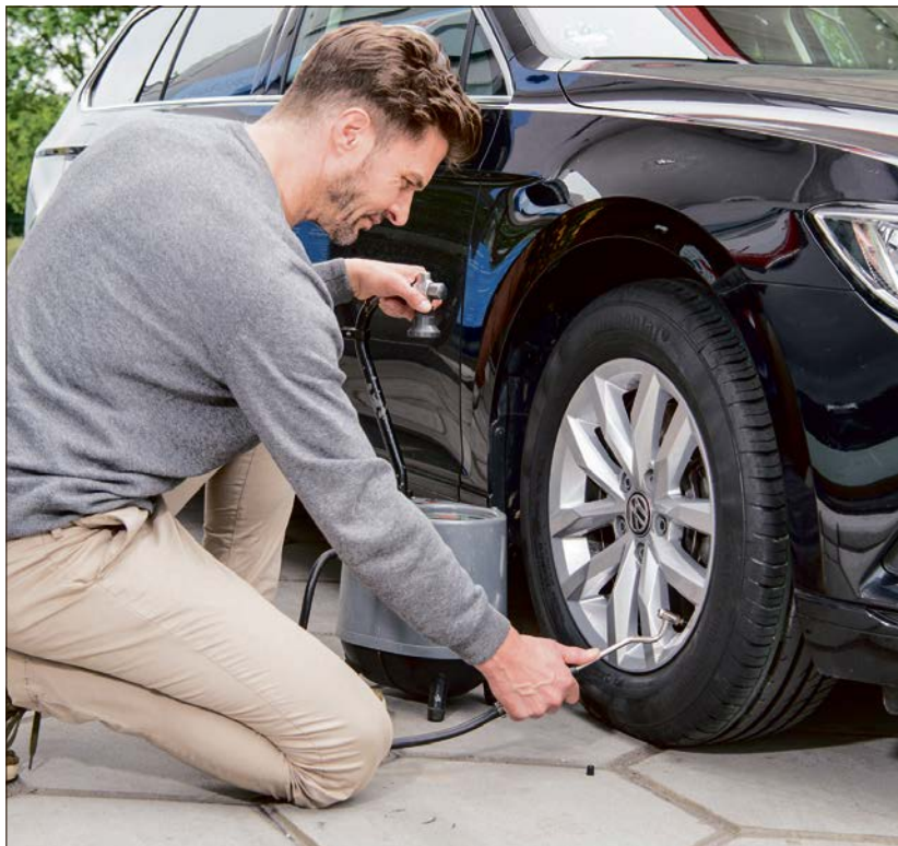
Regelmäßig checken: Durch den idealen Reifendruck kann auch der Kraftstoffverbrauch des Fahrzeugs optimiert werden. Werkfoto: Continental
