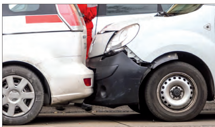
Bei höheren Aufprallgeschwindigkeiten sollte die Anhängerkupplung vorsorglich getauscht werden. Werkfoto: Rameder/Wodicka
