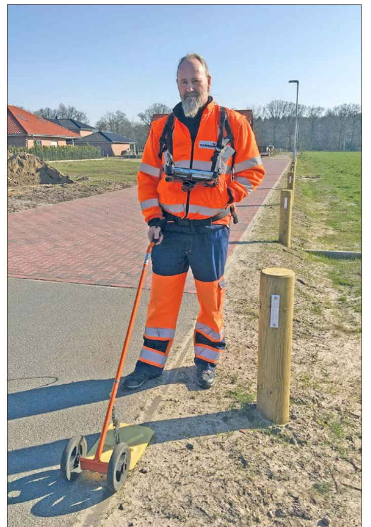
Thorsten Hiemisch prüft im Auftrag der Heidjers Stadtwerke das Gasnetz auf Dichtheit. Foto: Heidjers Stadtwerke
