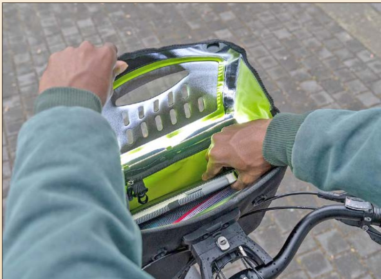
Das Innere der Lenkertasche ist beleuchtet. Die Stromversorgung erfolgt über eine Powerbank. Werkfoto: Ortlieb
